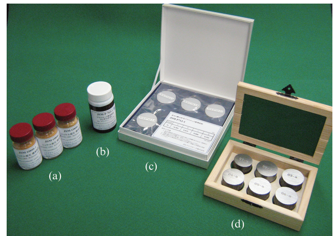
写真1 オリジナル標準試料 ((a) ニッケル鉱石、(b), (c) プラスチック、(d) 鉄鋼)
